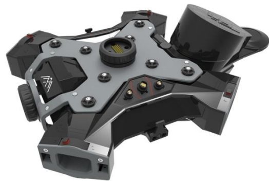
Der zentrale Körper von Tundra-M aus 3D Druck und Windform® SP.
