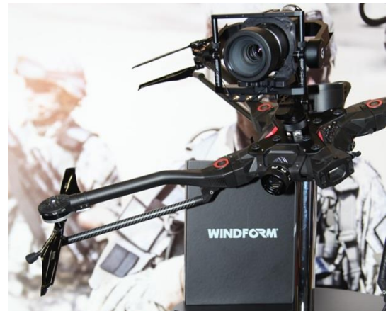
Die Arme von Tundra-M aus professionellem 3D Druck und aus Windform® XT 2.0.
