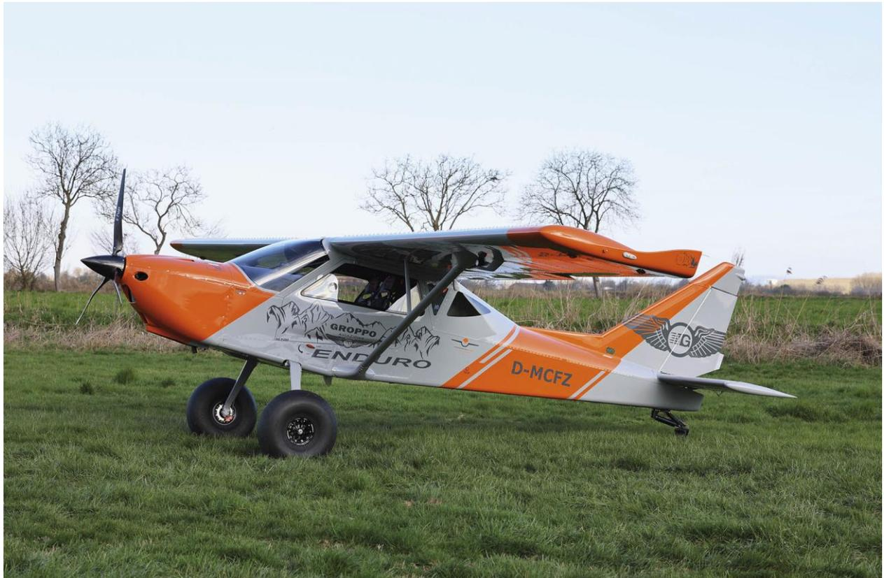
Die beliebte und bewährte GROPPO TRAIL-600 bleibt weiterhin als Bausatz und als Fertigflugzeug im Programm. Die GROPPO G70-600 wird als Standard-Bugradflugzeug und als Spornradversion ENDURO flugfertig bzw. als sogenanntes Almost-Ready-To-Fly-Kit angeboten, ein Schnellbaukit, bei dem der gesamte Metallbau im Werk vorgefertigt wird.
